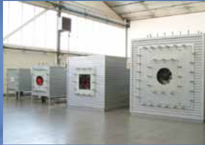
Túneles de ensayo caudal-presión
